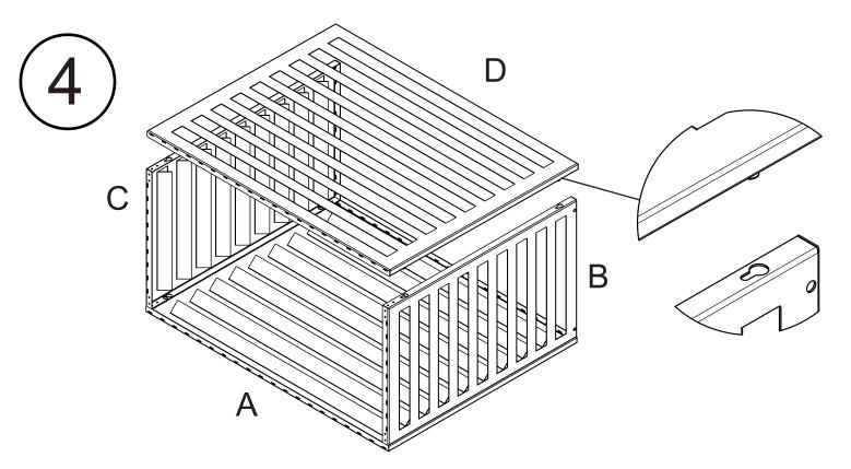
Befestigen Sie die hintere Abdeckung auf die gleiche Weise wie im vorherigen Schritt und ziehen Sie die Schrauben fest.
