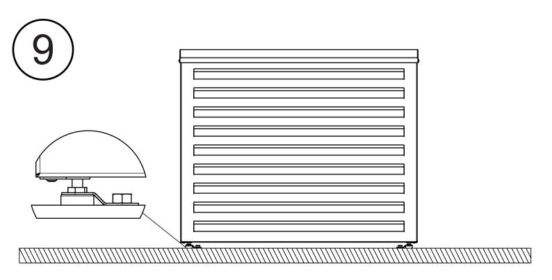
Setzen Sie die Abdeckung wieder auf und sichern Sie die Beine mit einer Mutter.
