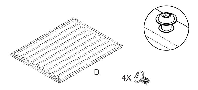
Schrauben Sie die Schrauben in die Gewinde ein. Montieren Sie die Schrauben so, dass sie nicht von selbst herausfallen.
