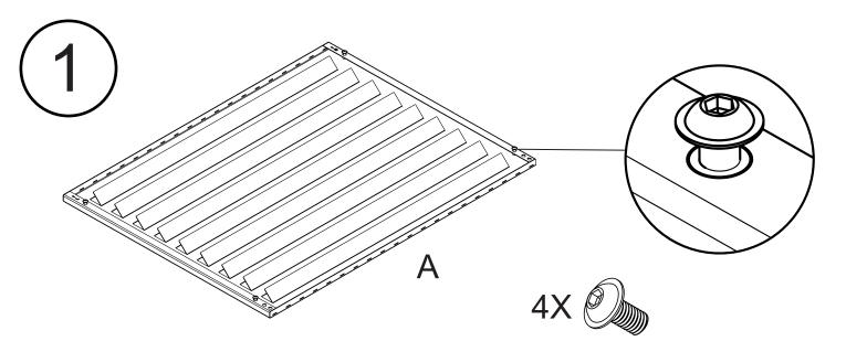
Schrauben Sie die Schrauben in die Gewinde ein. Montieren Sie die Schrauben so, dass sie nicht von selbst herausfallen.
