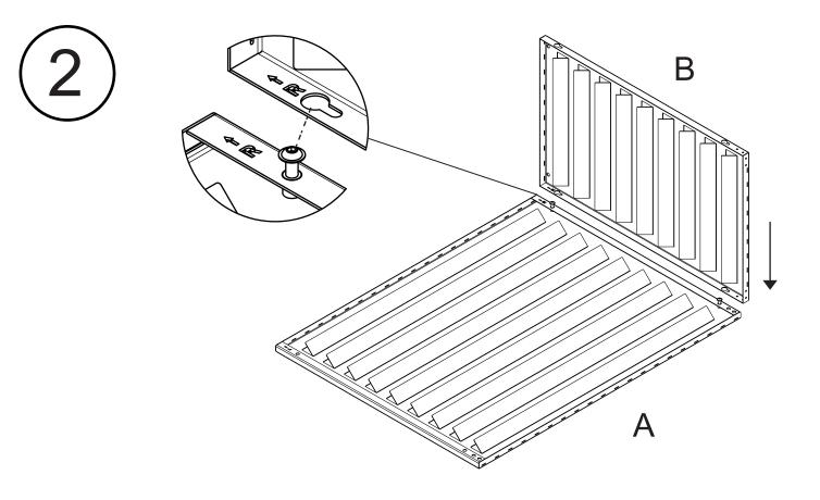
Befestigen Sie die Seitenteile an der Frontplatte (Symbole auf den Teilen immer spiegelverkehrt zueinander!).
