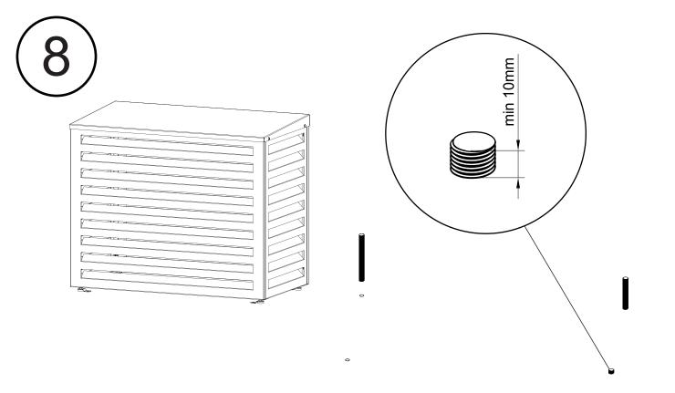
Bohren Sie Löcher und montieren Sie eine Gewindestange auf einem chemischen oder mechanischen Dübel. Lassen Sie die Gewindestange mindestens 10 mm herausragen.
